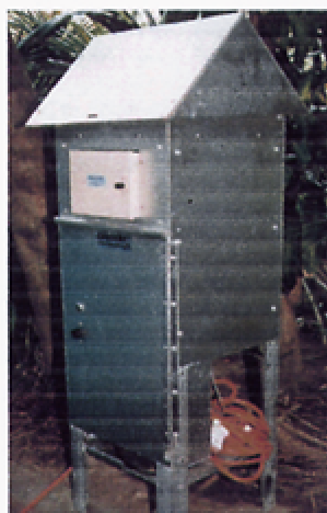
Figura 3. Medidor de Alto Volumen utilizado en la medición de partículas totales en suspensión.
